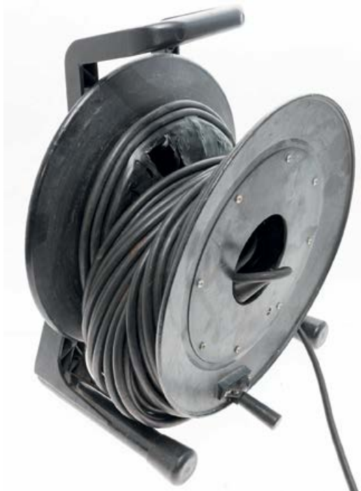
Mimośrodowy bęben powstały przez zbyt ambitne obciążenie zwiniętego kabla.
